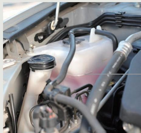
ラジエータ・リザーバ・タンク内の冷却水の量が規定の範囲 (FULLとLOWの間) にあるかを点検します。
