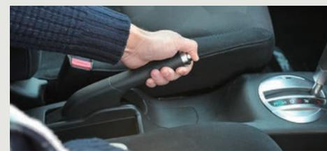
パーキング・ブレーキ・レバーをいっぱい引いたとき、引きしろが多すぎたり、少なすぎたりしないかを点検します。また、パーキング・ブレーキがペダル式のクルマは、ペダルの踏みしろで点検します。
