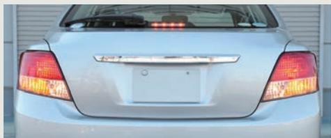
①エンジン・スイッチをONにして、ヘッドランプ、テール・ランプ、ライセンス・ランプ、ブレーキ・ランプ、クリアランス・ランプ、バックアップ・ランプなどの点灯具合やウインカ・ランプの点灯具合及び点滅速度が不良でないかを点検します。フォグランプ付車はフォグランプの点灯具合も点検しましょう。
