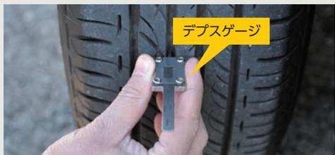
溝の深さが十分あるかをスリップ・サインなどにより点検します。なお、デプスゲージを使用すれば残り溝の深さがわかります。
