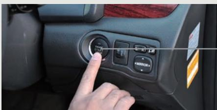
エンジンが速やかに始動し、スムーズに回転するかを点検します。また、エンジン始動時およびアイドル状態、異音がないかを点検します。
